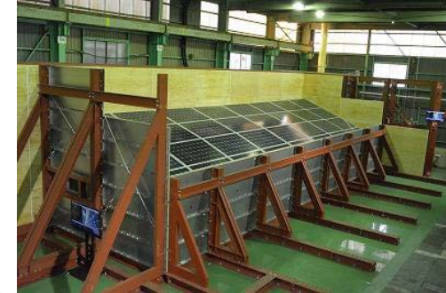
【安全ガイドラインの改訂に向けた研究】 強風時の太陽光発電システムの構造安全に係る研究開発（動風圧試験装置）
