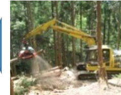
集めた木をプロセッサで丸太に切り分ける
