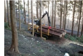
丸太をフォワーダで山土場に運ぶ(森林作業道)
