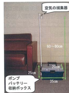
自宅の屋内・屋外に設置する機器による測定(成人調査)
