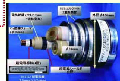
高温超伝導ケーブル
