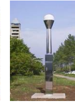
電子基準点 (GPS測量の基準)
