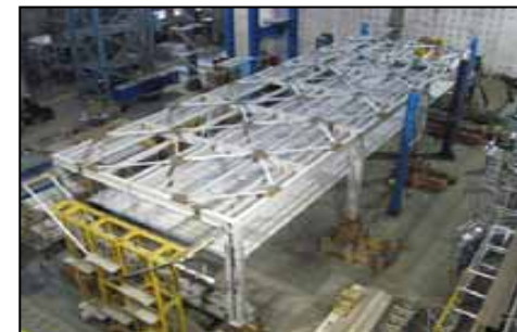
近年の地震における天井落下被害の原因解明のための実大振動実験
